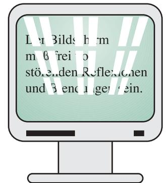
*Bildschirm mit starker Reflexblendung durch die Beleuchtung. Sie ist nicht nur Belastung des Sehvermögens, sondern auch eine „vorprogrammierte Fehlerquelle“.*
